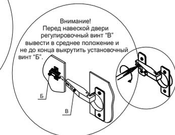
**!!!** Планки петель **16** установить на боковину правую или левую **9** в зависимости от стороны открывания двери. Не задействованные отверстия под планки петель на одной из боковин заклеить заглушками самокл. **17** !!!
