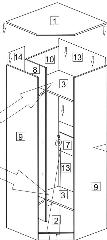
После установки ДВП [14, 13] в пазы, закрепить крышку [1] к боковинам [9], перегородке [8] и стенке [10]
