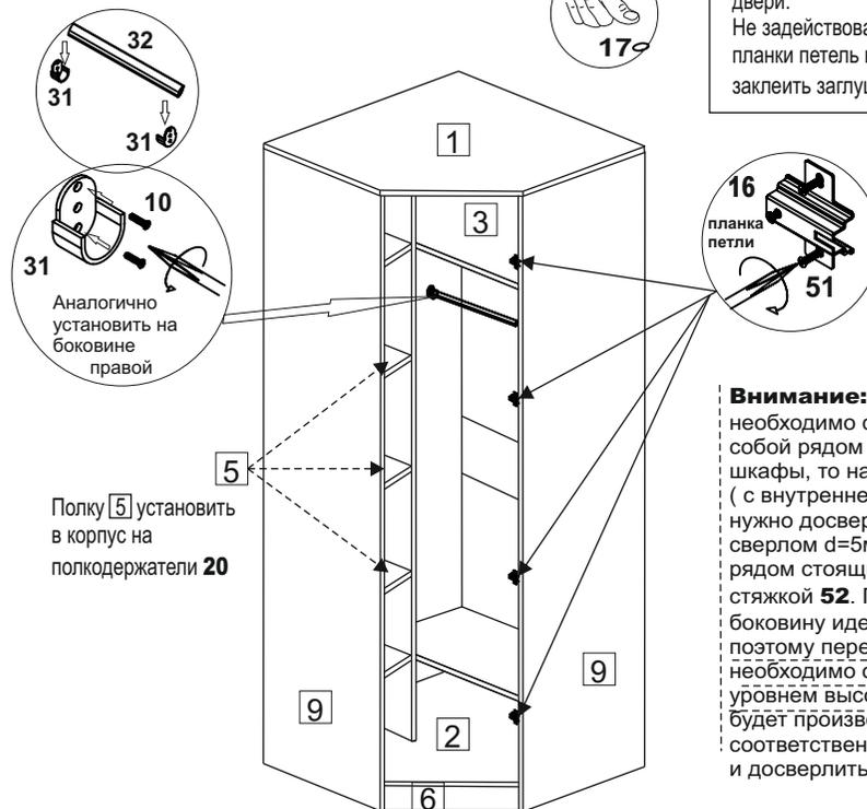
**Внимание:** Если вам необходимо стянуть между собой рядом стоящие шкафы, то на боковинах **9** (с внутренней стороны) нужно досверлить отверстия сверлом d=5мм, и стянуть рядом стоящие боковины стяжкой **52**. При этом на боковину идет по две стяжки, поэтому перед засверловкой необходимо определиться с уровнем высоты, на котором будет производиться стягивание, соответственно те отверстия и досверлить.
